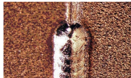
Obr. 2 – Horní strana vysoce kvalitního průběžného svaru, který je tvořen sérií překrývajících se bodů (pulsů). Materiál je nerez, použitý ochranný plyn Argon.
