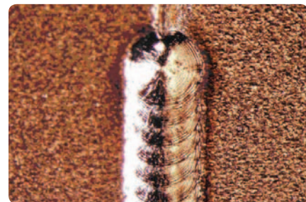
Horní strana vysoce kvalitního průběžného svaru, tvořený sérií překrývajících se bodů (pulsů). Materiál je nerez, použitý ochranný plyn Argon.
