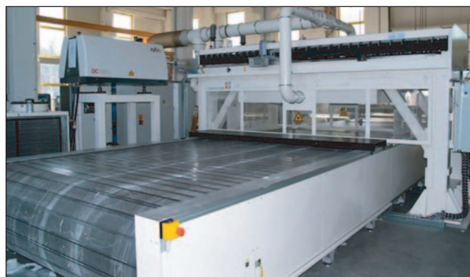
Systém Contilas pro řezání airbagů využívající technologie remote cutting a cutting on the fly s 2kW CO 2 laserem DC020
