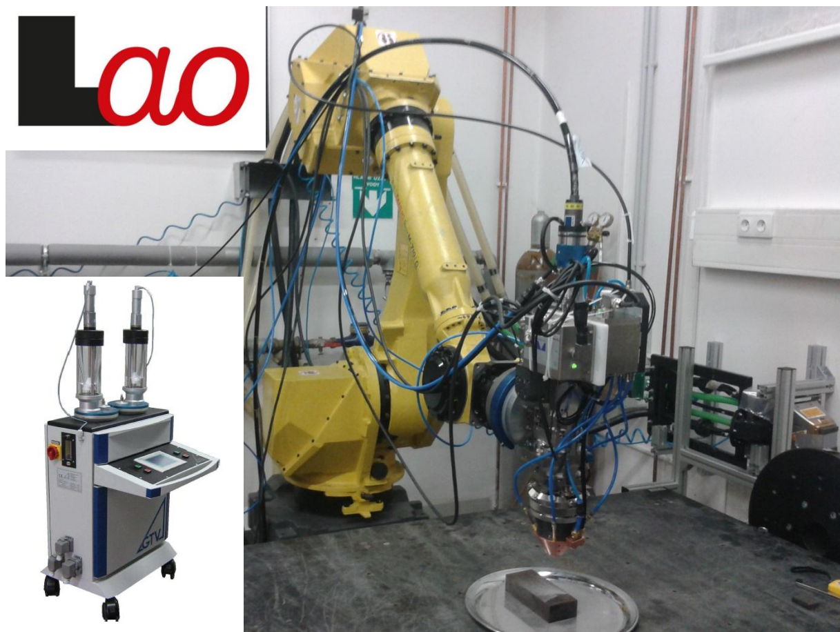
Obrázek 1 – Technologie navařování na robotu s podavačem prášku.
