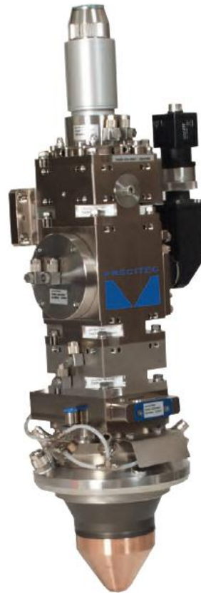
Obrázek 2 – Profil procesní hlavy po instalaci na robotickou ruku. Hlava je připevněna přes rychlospojky a její montáž a demontáž zabere jen pár minut. Výhodou je, že rychlospojka garantuje přesnost polohování do identické pozice \pm 0,01\text{mm} .
